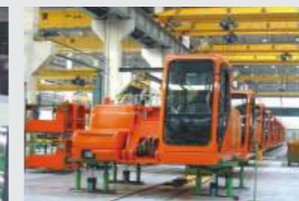
> 굴삭기 상부 조립 LINE
